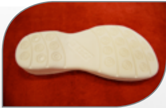
2.Máster rígido en escayola impresión 3D / Master rigid plaster 3D printing
